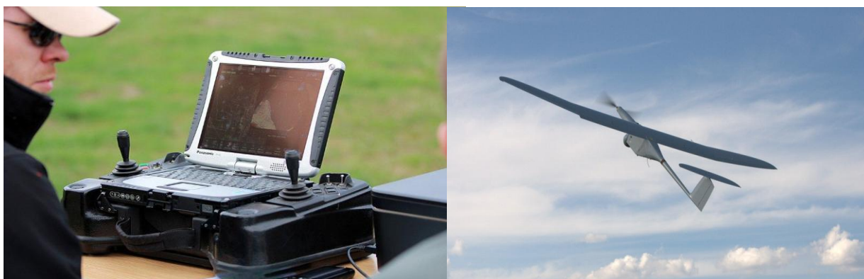
Zdjęcie nr 4,5: Stacja kierowania lotem oraz samolot FlyEye (zasięg około 30 km, wysokość lotu: 3000 m czas lotu 2 h, ), Źródło: www.wb.com.pl
